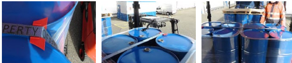
Sicherung der Fässer / drum securing
