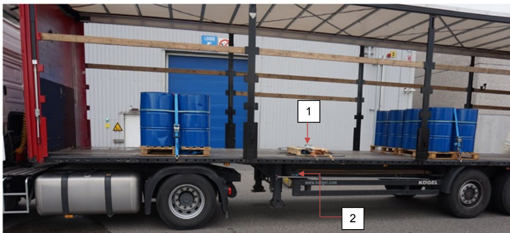
Positionen der Messeinrichtungen / Positions of the measuring instruments: 1. SAVER9X GPS ; 2. VBOX 3i
